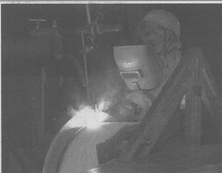
自動機による溶融池を溶接士が確認するマシン溶接
